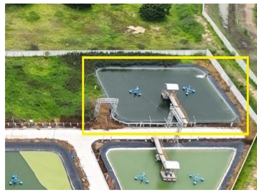
รูปที่ 3-19 บ่อพักน้ำทิ้งจากหอหล่อเย็นโรงไฟฟ้า (Holding Pond) ของนิคมฯ
